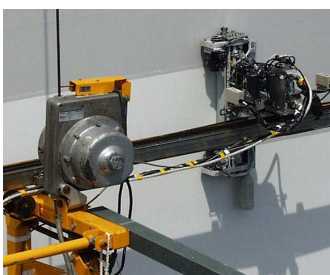
【主塔塗装ロボット2】
